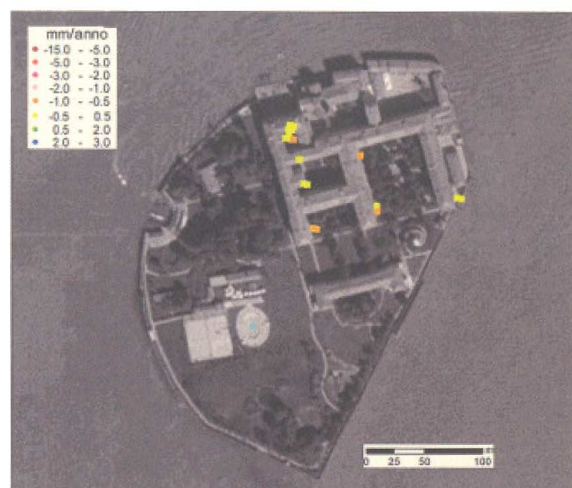
Fig. 3 Analisi dello spostamento delle isole dell'area lagunare attraverso il metodo IPTA
