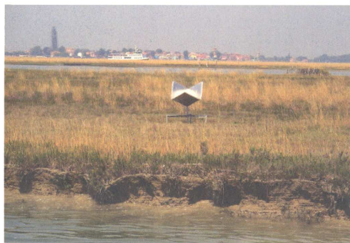
Fig. 4 Uno dei riflettori artificiali installati nella laguna di Venezia per la misura della subsidenza con tecniche di interferometria SAR
